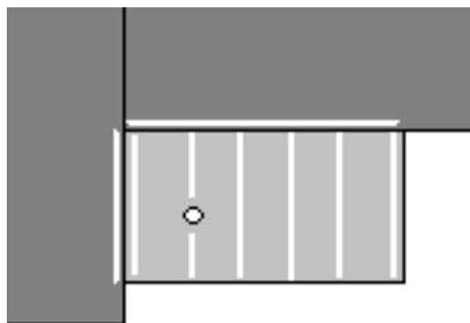
4- A continuación, instalaremos la válvula en el tubo de desagüe previamente ya instalado, y acoplaremos el plato de ducha haciendo coincidir con el agujero de la válvula, para su posterior fijación.
